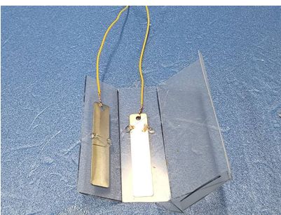
図の様に、2カ所に、銅板と亜鉛板を取り付けます（図では左が銅板、右が亜鉛板）
